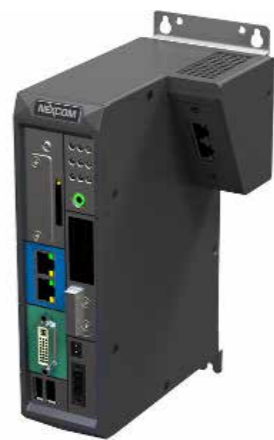
شکل ۵ - کنترلر PC بیس و مبدل IOT ۱۰۰ تولید شده توسط NEXCOM
