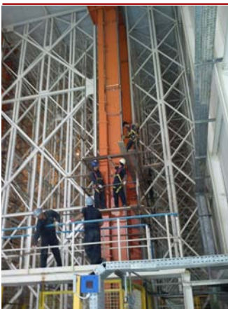
شکل ۱. سازه انبارش مرتفع (high bay warehouse) و یک جرثقیل انبارش (stacker crane)
