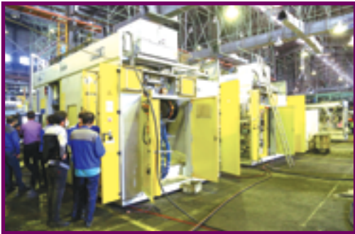
▲ تست تجهیزات خط AF200 ماشینکاری بلوک سیلندر
