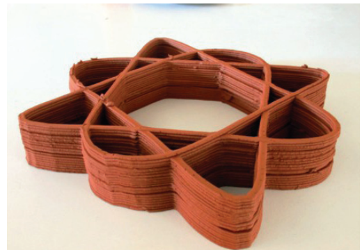
شکل هندسی سه بعدی با استفاده از تکنولوژی پرینتر سه بعدی رباتیک تام‌نامه / عکس: دریافتی Fabclay
