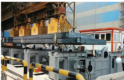
تست عملکرد دستگاه اسلب برگردان در حضور ناظر و کارفرما، تام/نامه/ عکاس: امیر حیدریان
