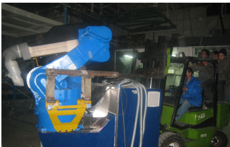
ساخت قطعه واسط برای جابجایی ربات با لیفتراک و ایجاد تعادل بار با خلاقیت نیروی انسانی
