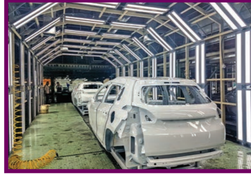
اجرای سیستم روشنایی zebra
