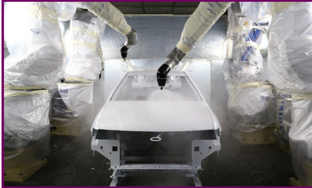
اجرای سیستم تمام اتوماتیک پاشش رنگ
