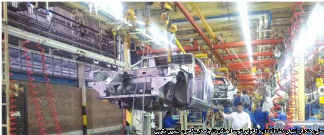
حمل بدنه از انتهای خط main به کاتوایر توسط هنگر، تام نامه/ عکاس: حسین شفیعی
